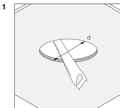
Сделайте отверстие в гипсокартонном потолке с диаметром (d), соответствующим выбранной модели (см. паспорт светильника).
